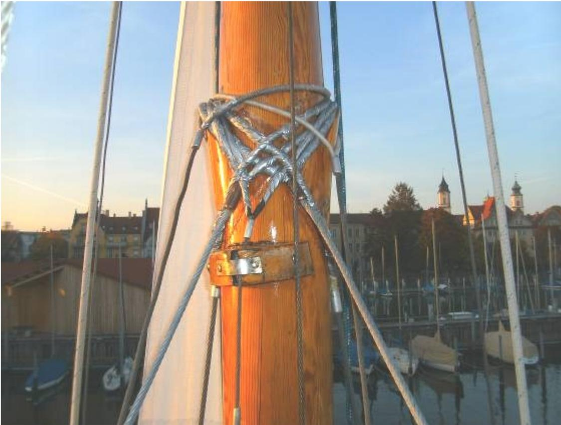
**Abb. 5 Hangeranordnung am unteren Mastteil**
