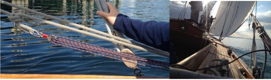
Die Grossschot wird durch drei Rollen an Deck und drei am Grossschotwagen geführt. Die durchlaufende Grossschot sollte so gefahren werden, dass beide Enden ausgeglichen lang sind. Das unterste Auge am Baumende wird zur Befestigung des Grossschotwagens verwendet damit beim Reffen die Befestigungsleine nicht mit in das Segel eingerollt werden kann. Dies kann nur vor dem Auslaufen durchgeführt werden!!
