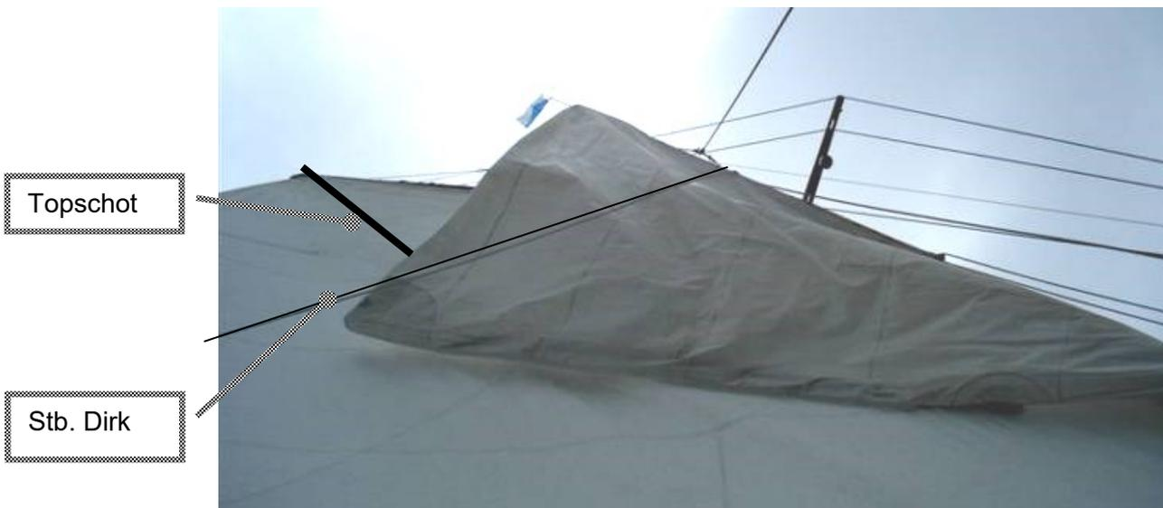
**Abb. 17 Topsegel setzen**
