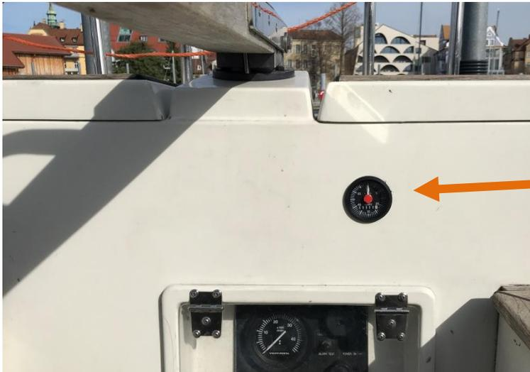
Betriebsstundenzähler (als Ersatz für die Anzeige im Kontrollpanel). **Er läuft bei eingeschalteter Zündung!**
