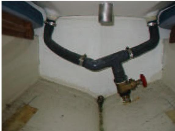
Im Falle einer Leckage an dieser Stelle kann das Boot untergehen! Sollte Wasser im Schiff festgestellt werden, so muss unbedingt diese Stelle kontrolliert werden, sofern dies noch ohne Selbstgefährdung möglich ist. Dies ist die einzige Rumpfföffnung im Unterwasserbereich.
