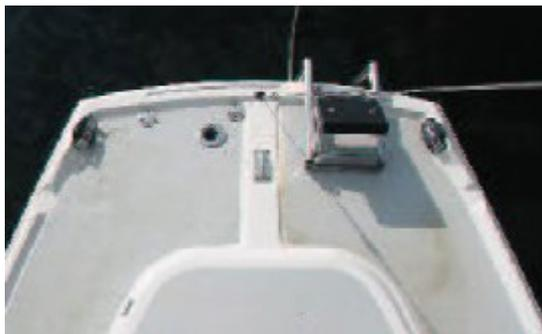
Bei Öffnen der achterlichen Backskiste z.B. zur Entnahme der Badeleiter, ist darauf zu achten, dass der Motor kurz nach vorne geschoben wird, um Kratzer am Deckel der Backskiste sowie dem Motor zu vermeiden.
