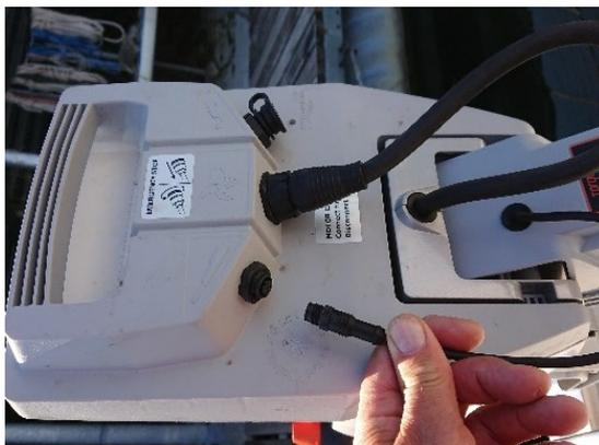
Anbringen des Kabels für das Steuergerät.
