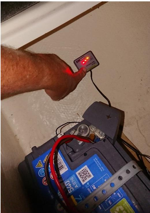
Sollte der Batteriewächter im roten Bereich anzeigen, so ist die Batterie aufzuladen. Ein Ladegerät ist entweder in der Schmiede oder beim Hafenmeister oder beim Bootsmann zu bekommen. Es funktioniert jedes herkömmliche Ladegerät für eine Autobatterie.
